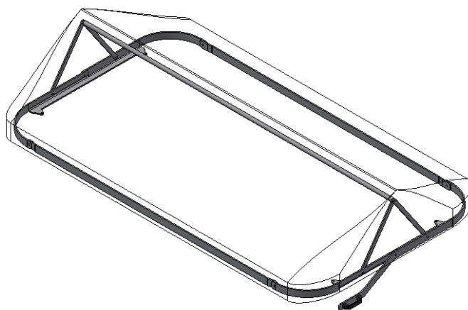
Figura 4.3 – Pantalla de cubierta con estructura plegable
